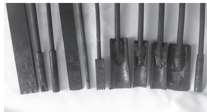
Фото 3. Підбір та розігрівання інструментів-«штампів» для випалювання
